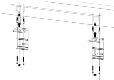
Abb. 1: Befestigung der Montage- winkel an die Decke
