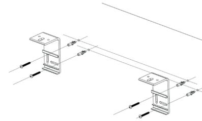
Abb. 3 Befestigung der Montage- winkel an die Wand
